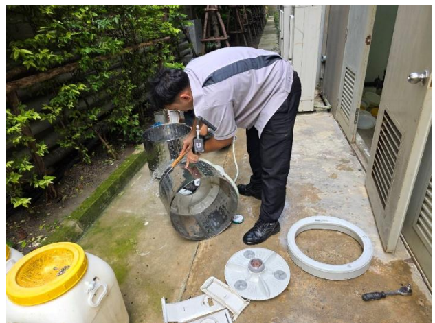
ช่างอาคารฯ ดำเนินการล้างถังเครื่องซักผ้า อาคาร A B และอาคาร C
